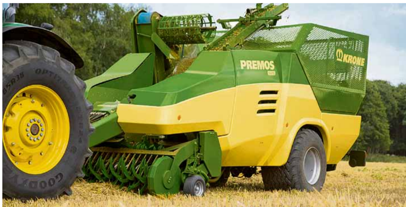
SO FUNKTIONIERT'S: Der Premos 5000 macht pro Stunde in einem Arbeitsgang aus fünf Tonnen Stroh Pellets. FOTO: KRONE
